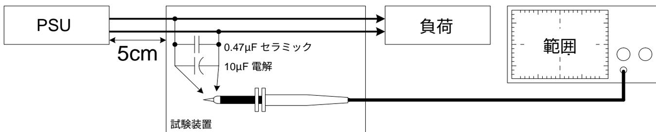
図 3 リップル&ノイズ測定回路
